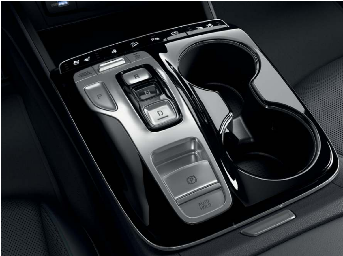
Nyomógombos, elektronikus váltóvezérlés.
