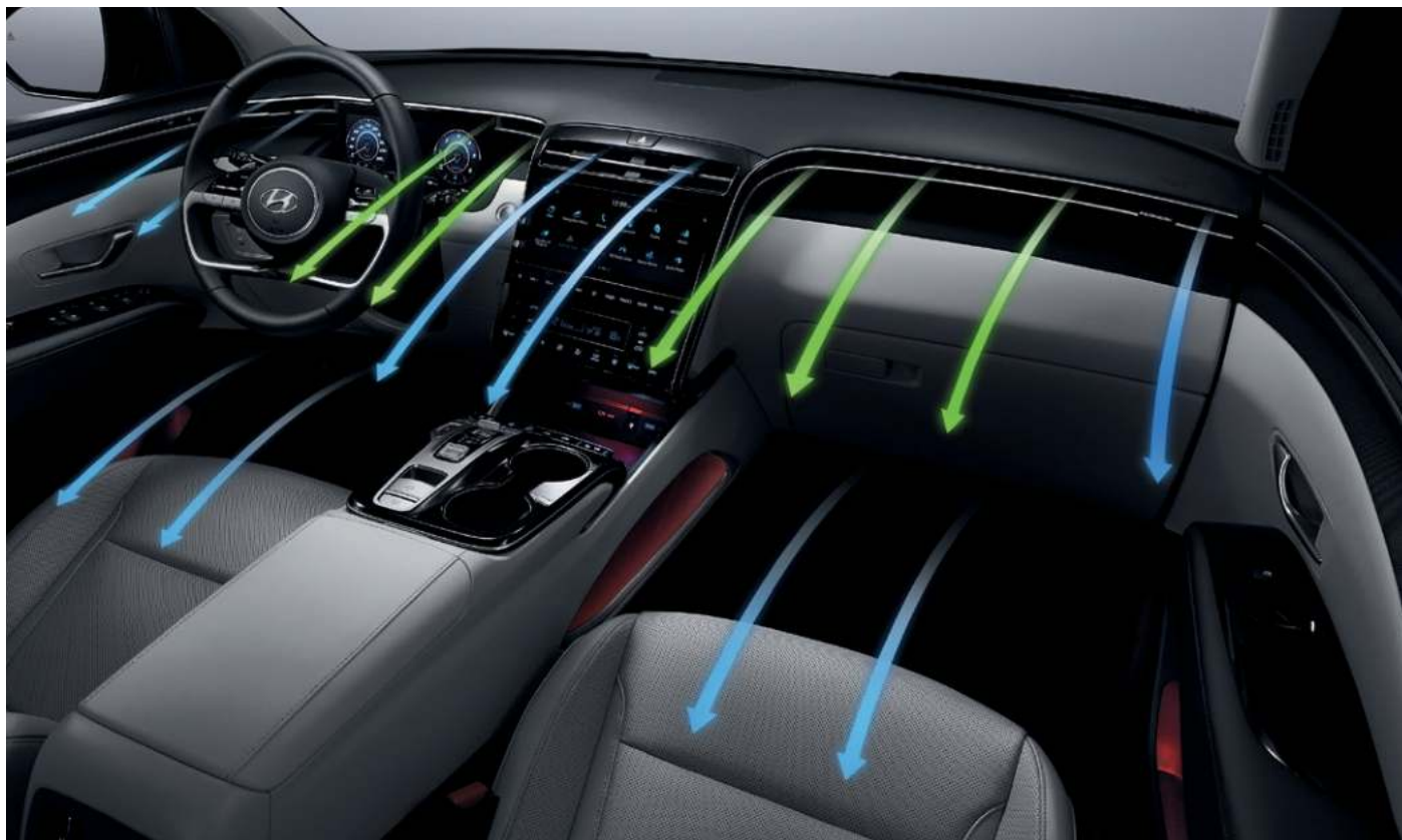
Multi Air üzemmód indirekt légbeömlő nyílásokkal.
